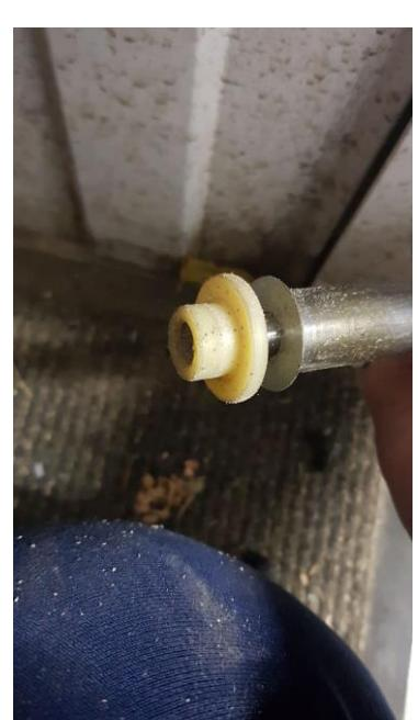
При сильном износе шейки вала и втулок- заказать комплект у производителя.
