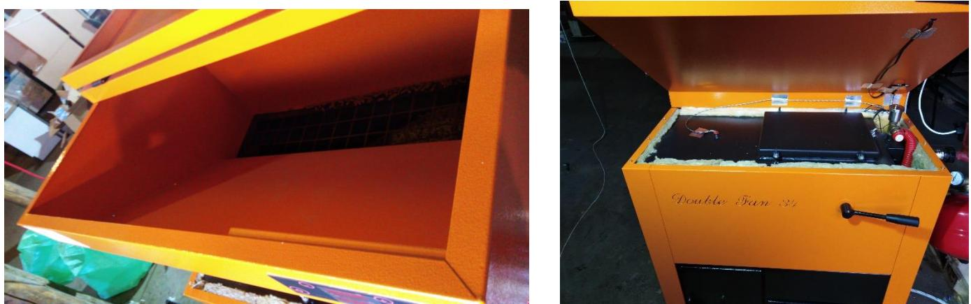
Проверить отсутствие подтеканий на клапане безопасности - спустить воздух, (проверить завоздушивание гидрострелки). Проверить целостность изоляции шлейфов и разъёмы термостатов, шлейфа дисплея, медного датчика защиты от перегрева.
