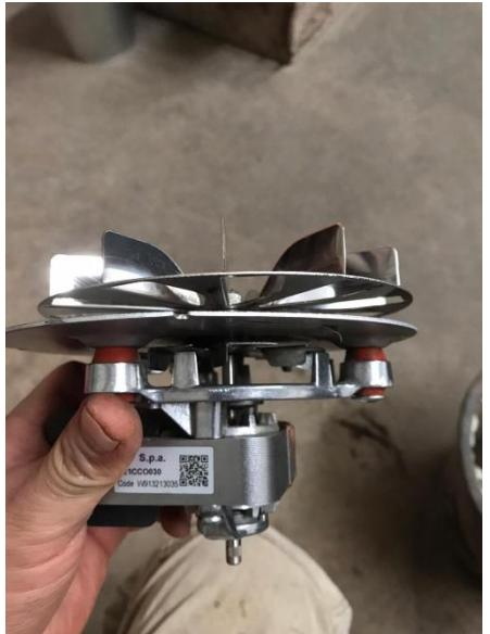
Очищенный и сухой вентилятор дымосос ставится на место с предварительно нанесённым термостойким герметиком (400C) по радиусу посадки.
