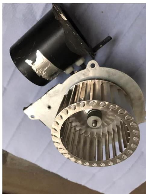
Установить вентилятор на место, Проверить уплотнение фольгированной лентой на вентиляторе подачи воздуха Fan 1 - это важно!
