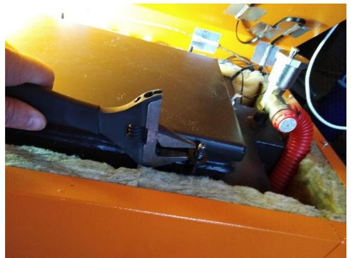
Внутренние гайки M8 (4шт) на удерживающей плиту пластине, надо аккуратно подтягивать, чтобы устраниить люфт между прижимной плитой и крышкой. Соблюдать осторожность что бы не повредить плиту вермикулита. Если на плите есть сколы, трещины или жаропрочные винты сломаны- заказать у Поставщика замену.
